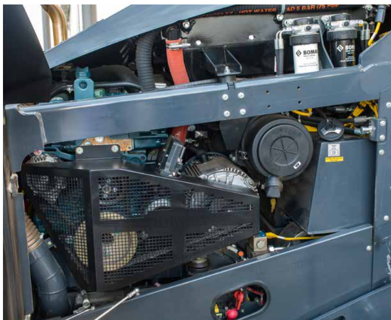
Di serie: libero accesso ai punti di manutenzione e protezione dalle parti in movimento grazie alla griglia di protezione.
