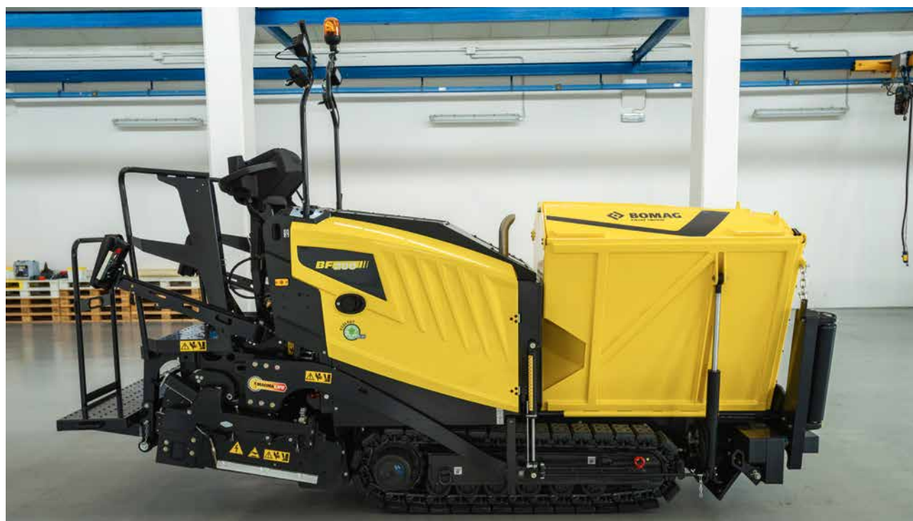
Il comando dei singoli cingoli consente di manovrare la macchina negli spazi più ristretti.
