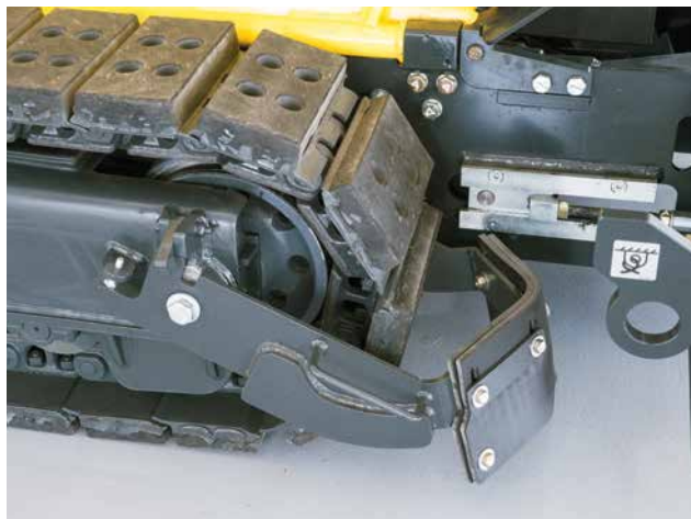
I raschiatori a catena riducono l'entità dei lavori di manutenzione.
