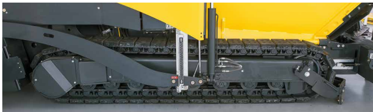
Il comando dei singoli cingoli consente di manovrare la macchina negli spazi più ristretti.
