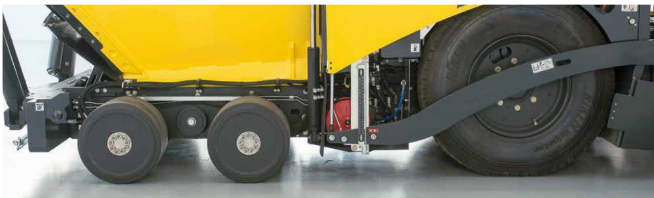
Trasmissione 6 x 6 opzionale per la massima forza di trazione.
