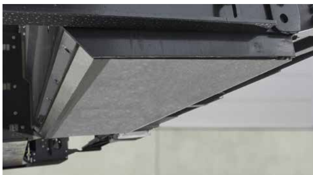
Piastre di usura basse per una perfetta planarità.
