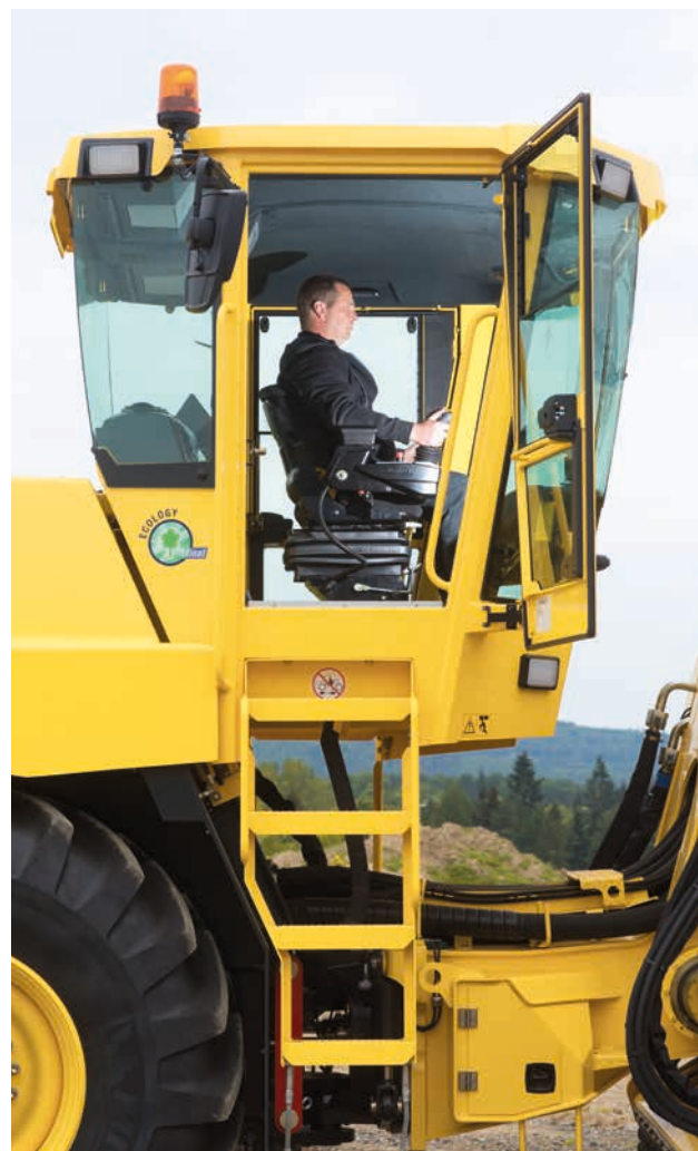
Il sedile che ruota di 270° offre un'eccellente visuale anche in retromarcia.
