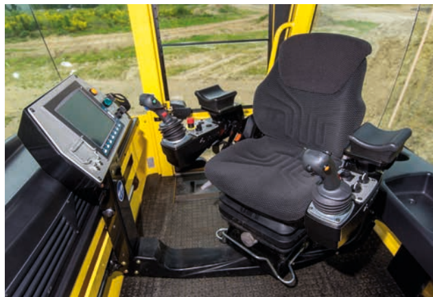
Il display serve solo per la visualizzazione e la gestione dei sistemi di dosaggio.
