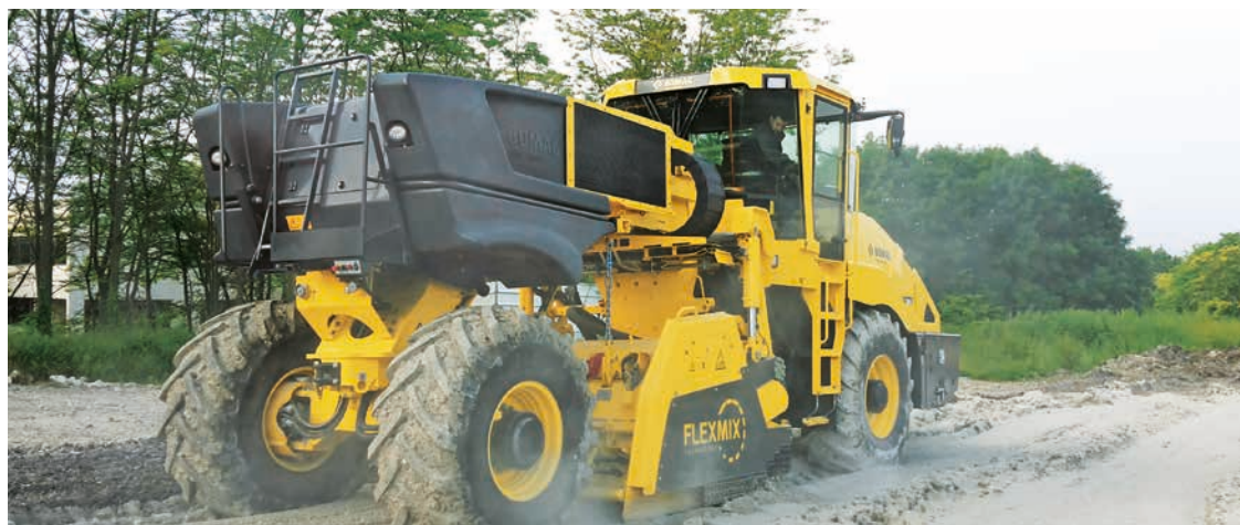
Omogeneizzazione di terreni coerenti fino a una profondità di 50 cm.
