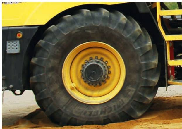
Ruote sovradimensionate per una bassa pressione sul suolo.
