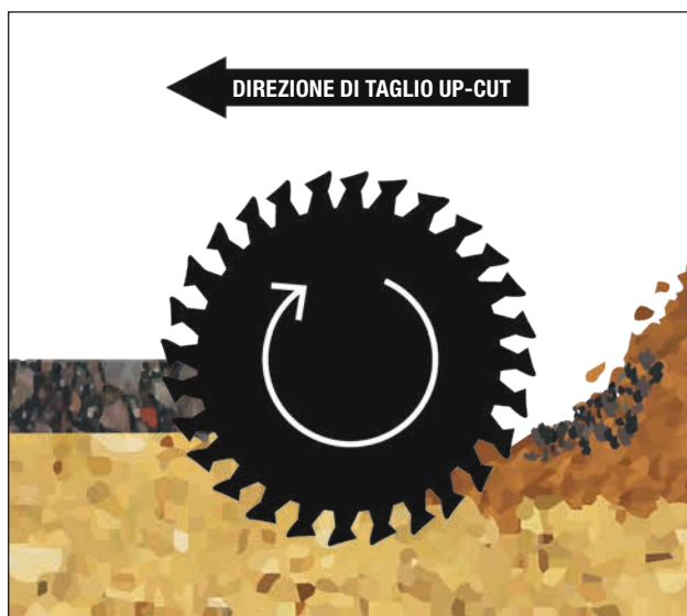
Direzione di taglio up-cut: rottura dell'asfalto dal basso.
