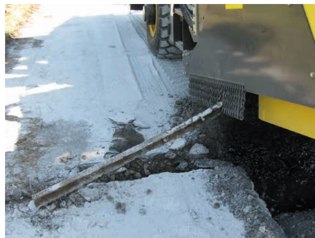
Il dispositivo idraulico di protezione contro sovraccarichi protegge da spiacevoli "sorprese".
