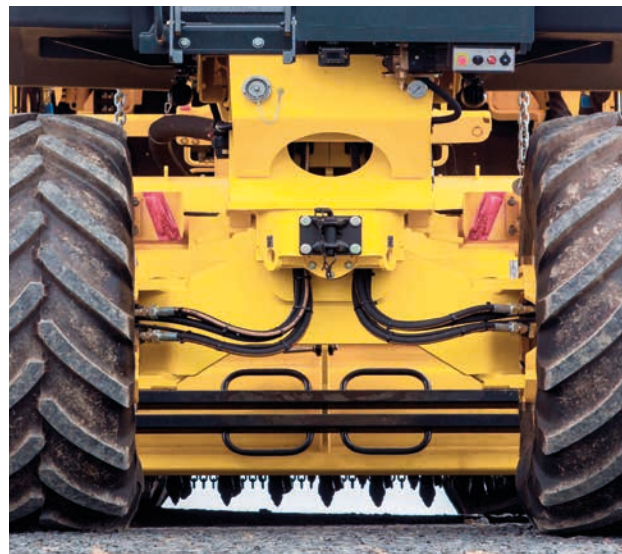
Asse posteriore con potenti trasmissioni individuali (RS 500).
