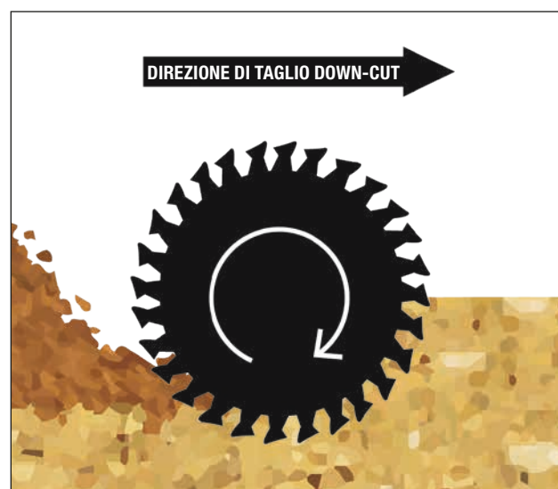
Direzione di taglio down-cut: miscelazione del terreno dall'alto – la trasmissione del rotore favorisce la trazione.
