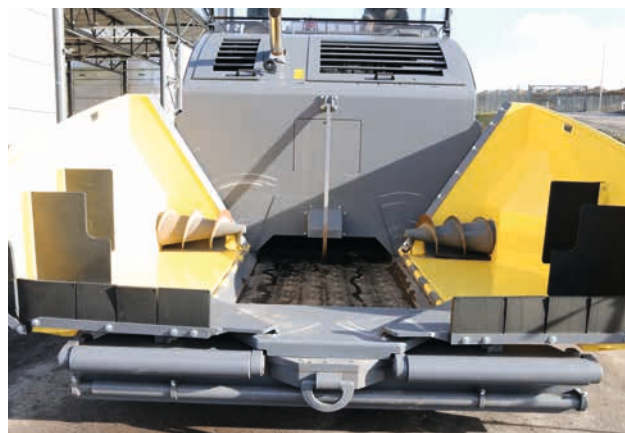
Deux vis pour un débit homogène du matériau.
