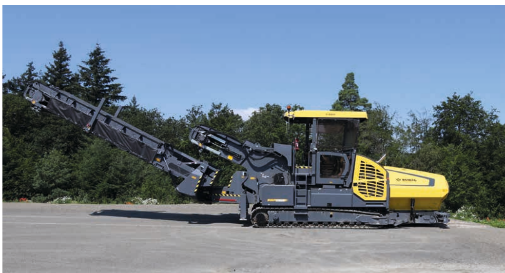
BMF 2500 S Offset avec convoyeur pivotant pour la version courte.
