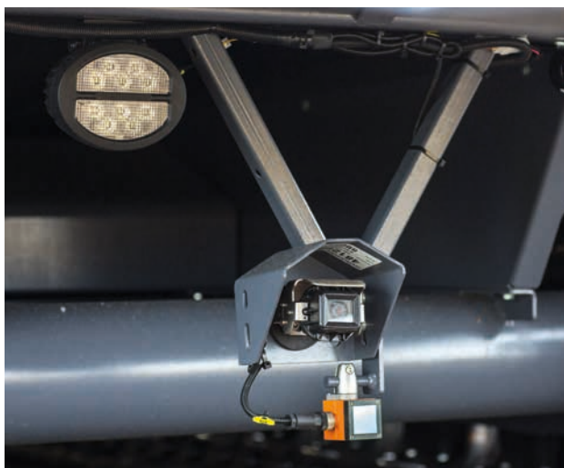
Vitesse synchrone : le capteur de distance.
