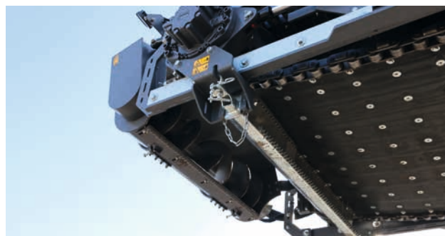
Unité de malaxage à l'extrémité du convoyeur.
