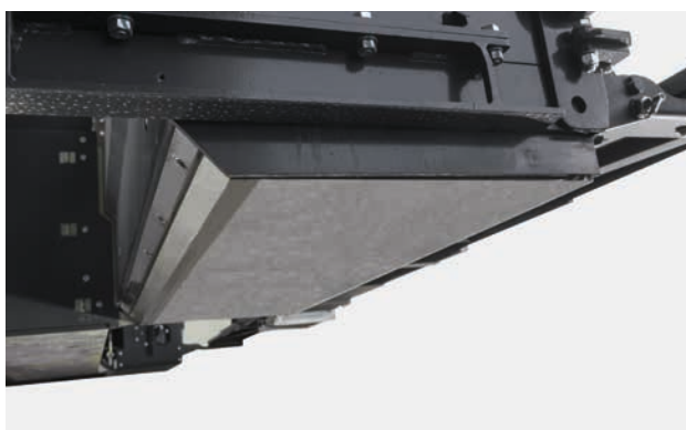
Piastre di usura molto lunghe, per una planarità perfetta dell'asfalto.
