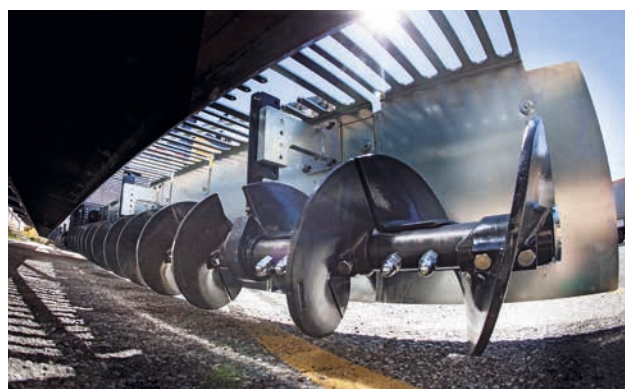
Coclea da 400 mm in ghisa resistente all'usura.
