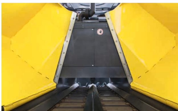
Flusso di materiale senza interruzioni: il nastro trasportatore a raschiamento reversibile.
