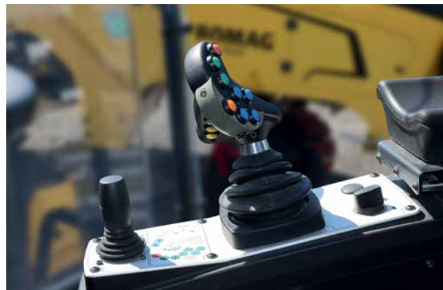
Tutto in una mano: leva di comando multifunzionale.
