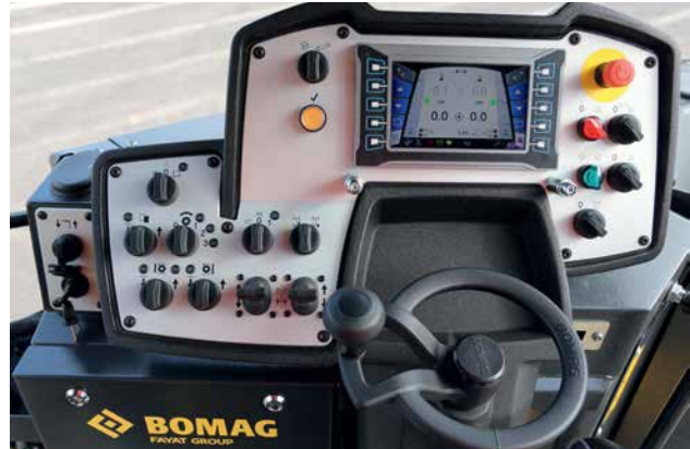
Tutto sott'occhio: pulsantiera regolabile con display a colori da 7".
