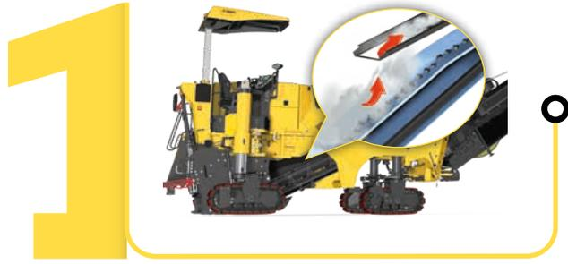
Innanzitutto le polveri vengono aspirate nel punto in cui si formano (nel passaggio tra la campana e il nastro trasportatore).
