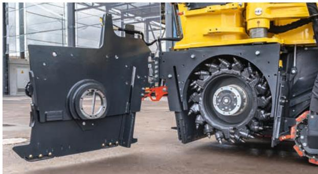
Protezione antiusura sostituibile in metallo duro della campana e del tamburo fresante.
