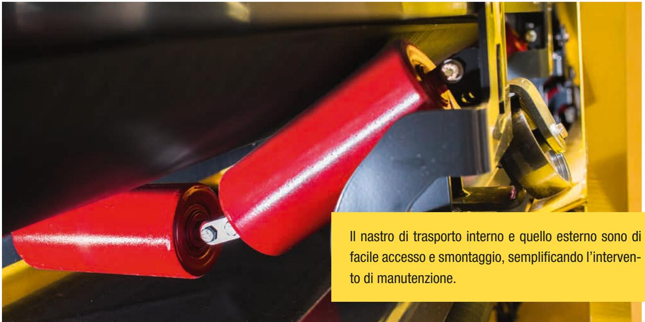
Il nastro di trasporto interno e quello esterno sono di facile accesso e smontaggio, semplificando l'intervento di manutenzione.
