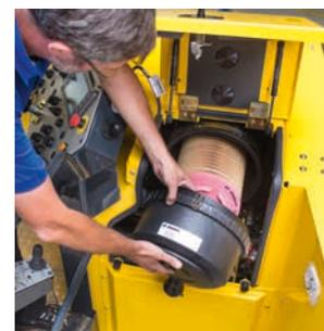
Anche la sostituzione del filtro dell'aria è facile e veloce.
