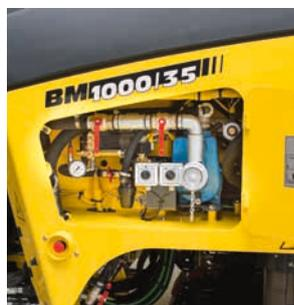
L'impianto idraulico è di facile manutenzione, poiché i componenti sono posizionati in modo ben visibile.
