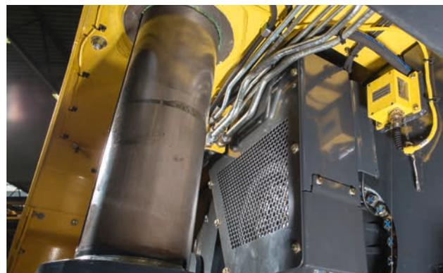
Carrello porta cingolo e colonne di sollevamento hanno una struttura particolarmente solida. Il maggiore diametro delle colonne comporta una minore pressione superficiale e di conseguenza una maggiore durata delle guide.
