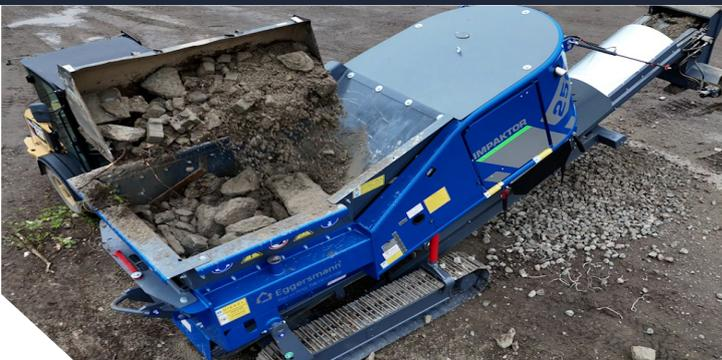
Il robusto Eggersmann IMPAKTOR 250 è progettato per la frantumazione di materiali minerali – nello specifico, detriti edili e calcestruzzo – o la triturazione di differenti tipologie di scarti. La macchina presenta dimensioni di trasporto ottimali e si distingue per gli elevati volumi di lavorazione. Punti di forza del prodotto
