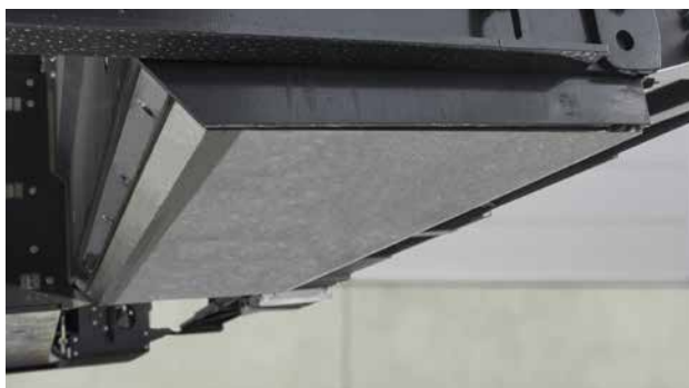
Piastre di usura basse per una perfetta planarità.
