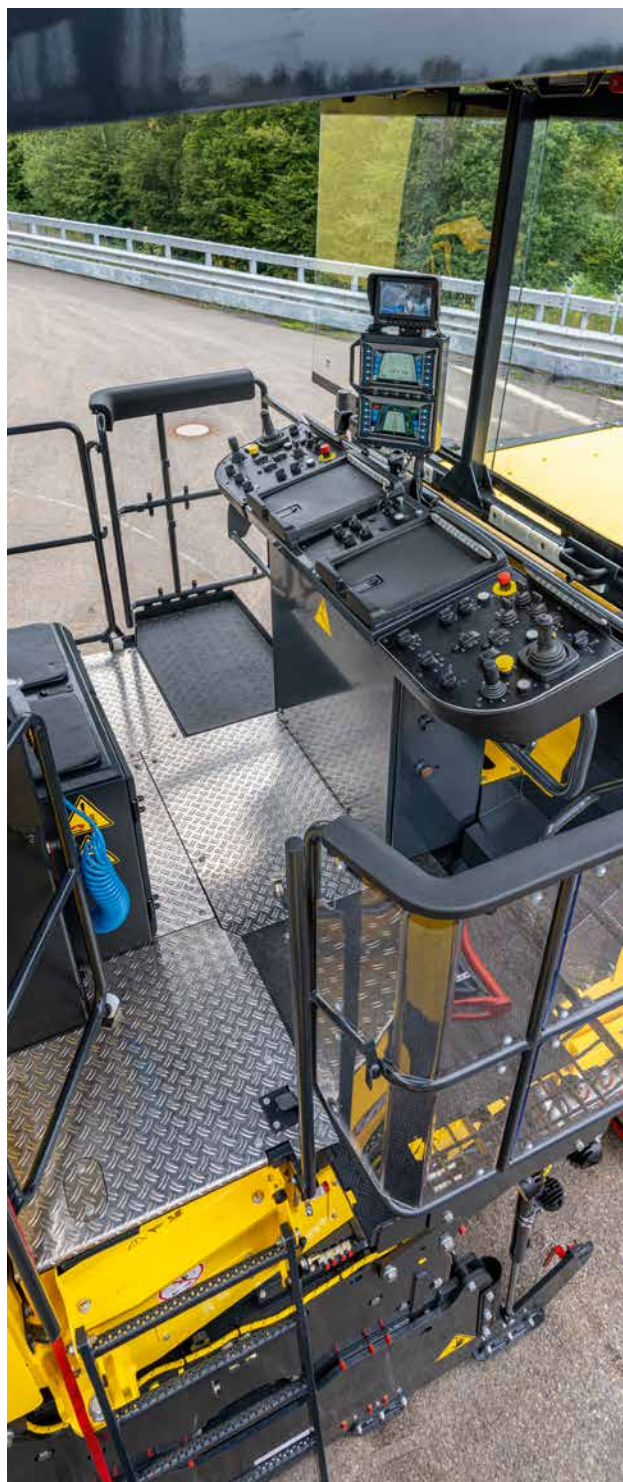
Progettato per offrire una maggiore visibilità e processi di lavoro intuitivi: il posto di guida con pulsantiera principale orientabile.
