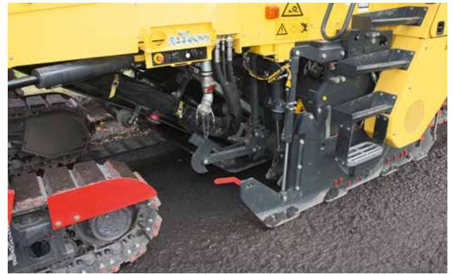
L'isolamento ottimale del nastro trasportatore interno aumenta l'affidabilità e riduce l'esposizione alla polvere.
