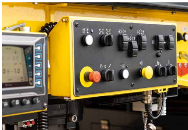
Dotazione di prima qualità per il secondo operatore: pulsantiera e display aggiuntivo sulla cabina di comando a terra.
