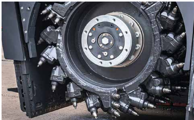
Protezione antiusura sostituibile in metallo duro del vano di fresatura e del tamburo.
